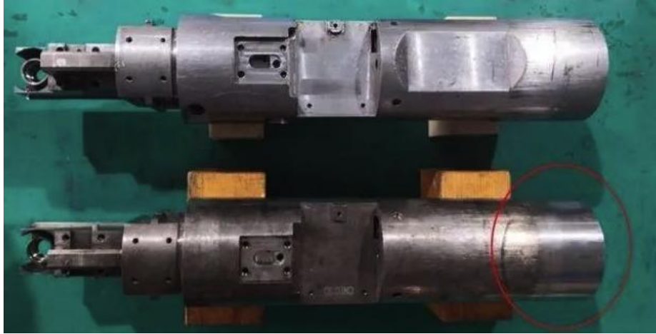
图 10 基于增材制造技术修复的 ESCT 井壁取心测井仪
